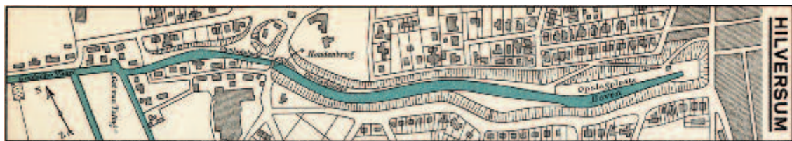
Situatieschets van het kanaal rond 1924. Vanaf de Hondenbrug bij de Oude Loswal is het tracée ingegraven in de stuwwal tot een diepte van 10 meter. Bron: Rapport PW Hilversum, 1980.
